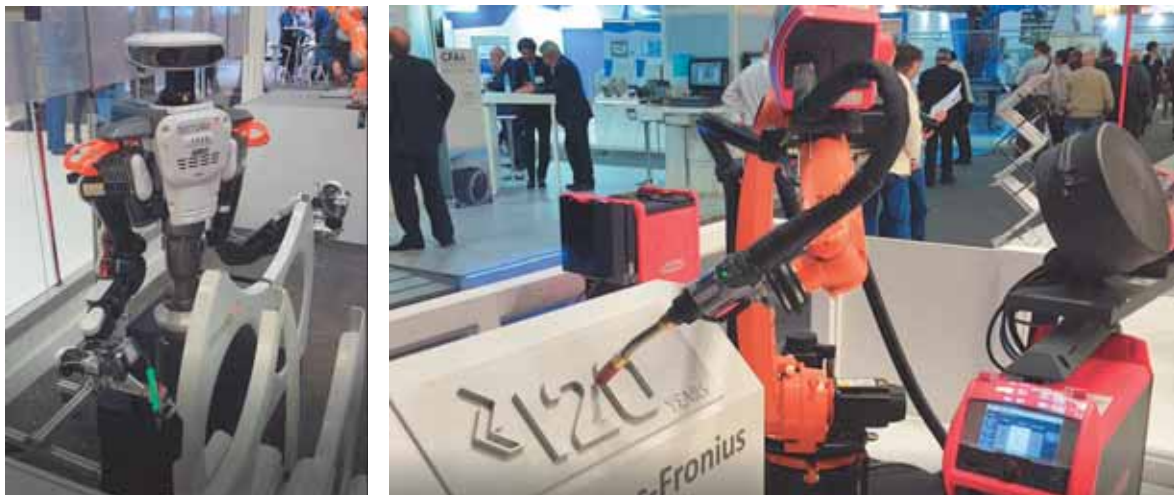
Figura 4. Operaciones de montaje con robots antropomórficos (izq) y soldadura autimanzada MIG/MAG (der).
